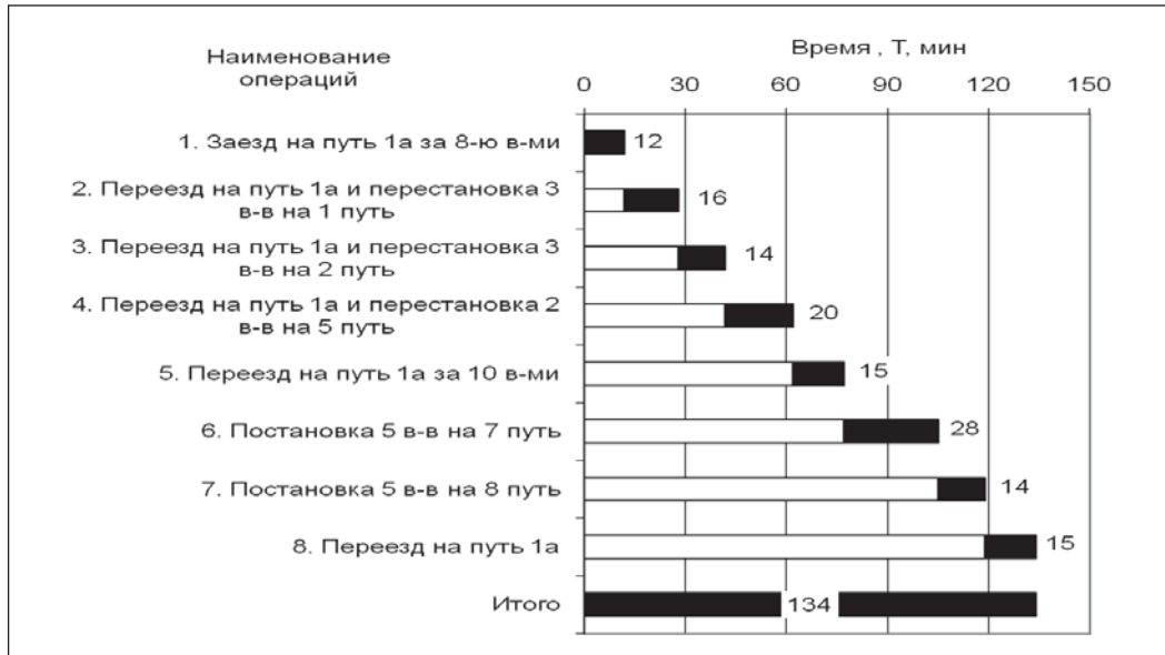
Рис. 4. Технологический график обслуживания ТГК ЦХП с применением локотрактора (постановка под погрузку)
